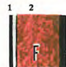
1. Karossplåt. 2. 26-lagrad fiberkomp- platta.
