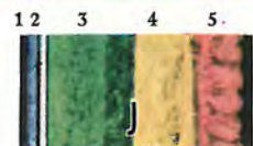
1. Sprutad asfaltkomp. 2. Plåt. 3. Asfaltkomp-platta. 4. Jute- väv. 5. Matta.
