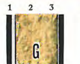
1. Karossplåt. 2. Juteväv. 3. Isolations- fiber.
