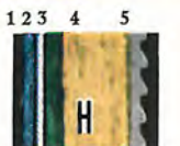
1. Sprutad asfaltkomp. 2. Plåt. 3. Asfaltkomp- platta. 4. Juteväv. 5. Gummi.
