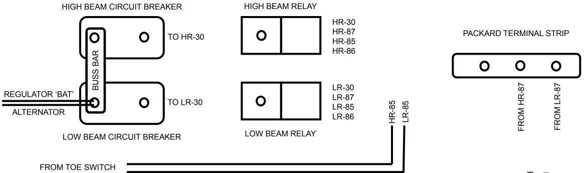
TOE SWITCH LEADS ARE DISCONNECTED FROM PACKARD TERMINAL STRIP AND ROUTED TO RELAY PINS 85 RELAY PINS 86 ARE GROUNDED 6 VOLT NEGATIVE CABLE IS CONNECT TO EITHER SIDE OF BUSS BAR OUTPUT OF CIRCUIT BREAKERS ARE ROUTED TO RELAY PINS 30 OUTPUT OF RELAYS, PINS 87 ARE ROUTED TO PACKARD TERMINAL STRIP
